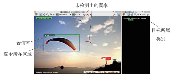
图3 翼伞检测结果
