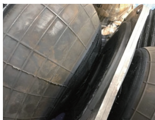
图15 疲劳试验后样品照片
