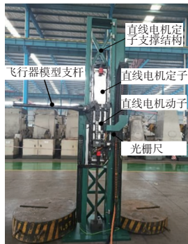
图 12 动导数实验装置实物图
