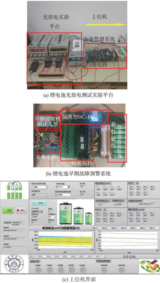
图3 锂电池均衡控制实验平台
