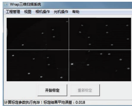
图3 Win3D型扫描仪的精度标定
