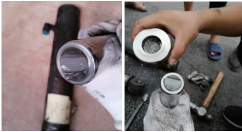
图 4 当前活塞杆失效断裂举例
