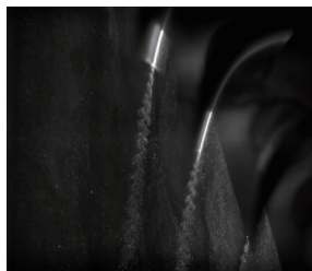
图 9 试验所捕捉到的 1 帧原始粒子图像
