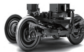
图 2 日本川崎重工 CFRP 转向架
