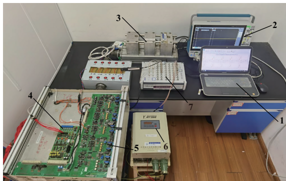
1—上位机; 2—示波器; 3—磁悬浮转子实验台; 4—传感器电路; 5—功放驱动电路; 6—变频器; 7—dSPACE控制系统。
