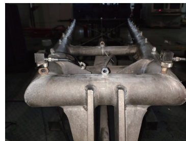
图4 受电弓上框架现场试验图
