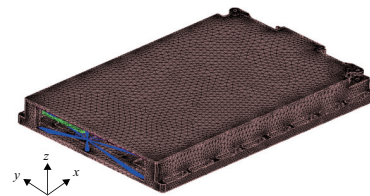
图 3 单机有限元模型和对应坐标系
