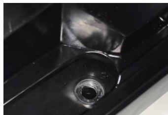
图4 安全带导向塑料件压溃
