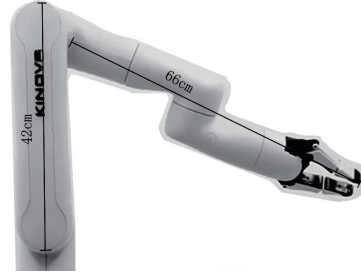
图 2 杠铃片夹取设备
