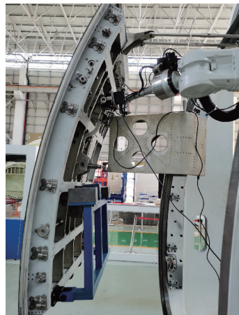
图10 耐久性试验真实试验场景图
