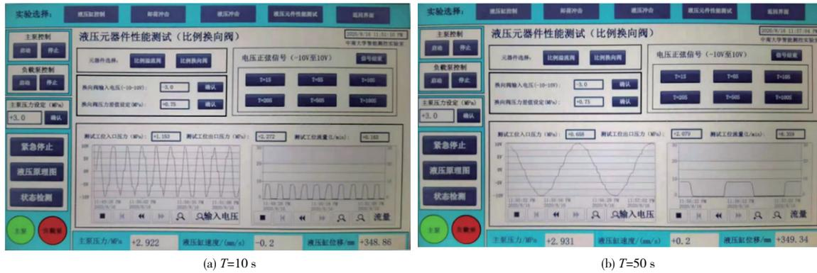
图 8 主泵压力为 3 MPa 比例换向阀的性能测试试验图
