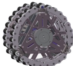
图2 基于轮式设计的轮履重构结构
