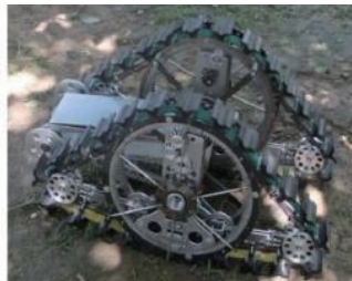
图3 基于履带式设计的轮履耦合结构
