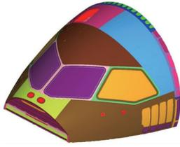
图1 某型民机承载式风挡有限元模型
