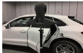
图 2 关门声品质测试
