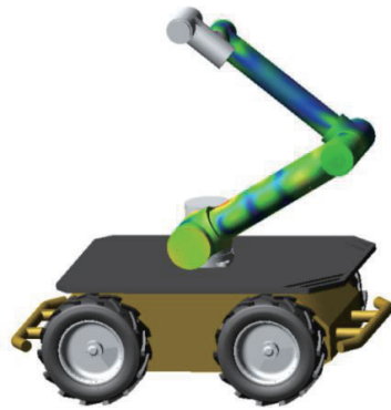
图7 移动机械臂刚柔耦合模型
