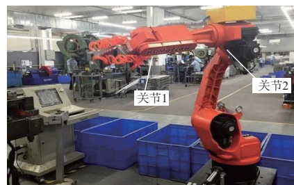
图 2 柔性多关节移动机器人结构示意图
