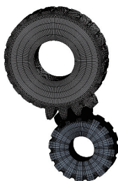
图 3 轮齿接触模型网格划分
