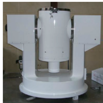
图 2 双轴测试转台台体
