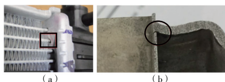
图4 散热器冷热交变典型失效模式
