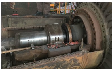
图 10 长期运行的排气缸
