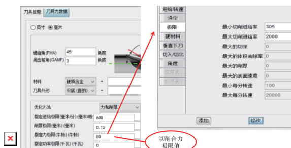
图5 根据力极限值设定机床安全切削参数范围
