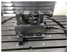
图 4 SiC/SiC 复合材料装夹于三向动态测力仪
