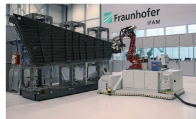
图 8 ProsihP II 系统加工 A320 垂直尾翼的外壳
