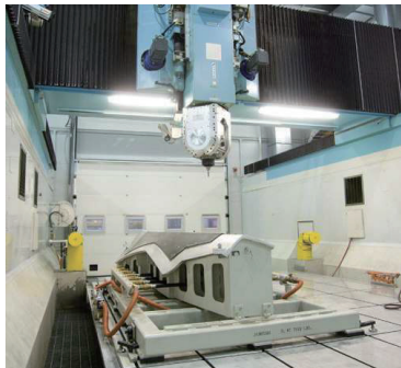
图 7 精密五轴龙门加工中心对 F-35 复合材料蒙皮进行精密铣削和钻孔
