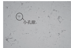
图 9 优化后切片试样在金相显微镜下的金相组织
