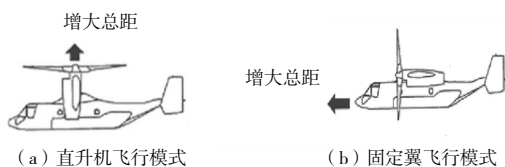
图2 不同飞行模式总距操纵示意图
