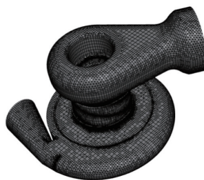
图1 离心泵网格模型
