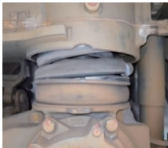
图1 一系钢簧断裂图片
