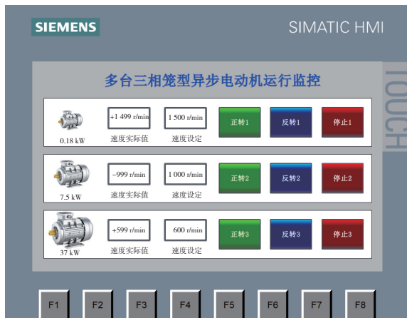
图4 多台电动机运行监控画面组态
