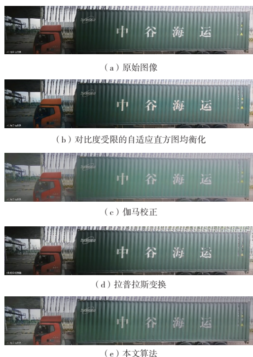
图 3 用不同图像处理方法增强货车集装箱图像对比度的结果
