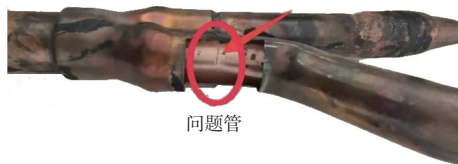
图 1 产生裂纹的分歧管示意图
