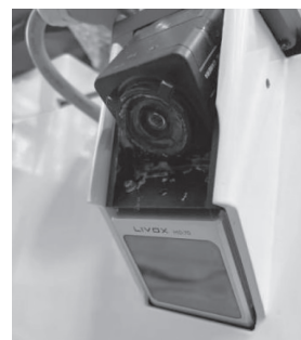
图 5 相机与激光雷达安装方式
