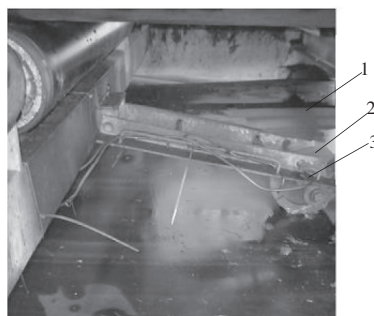
1—输送带;2—检测轮;3—接近开关。
