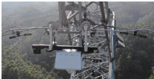
图 2 机器人巡检输电导线行走环境实验场景
