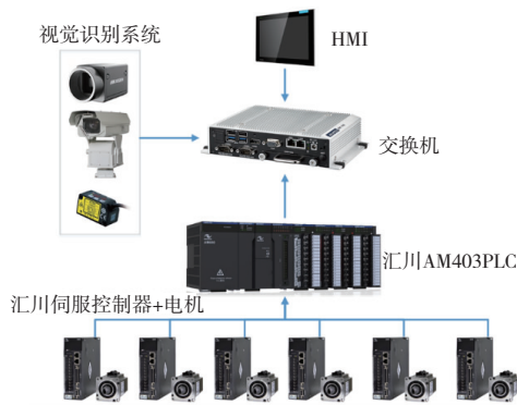
图2 控制系统架构
