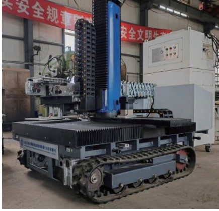
图1 集装箱卸货机器人本体结构
