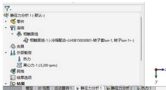
图6 过盈、热力、离心力综合加载
