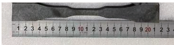
图4 陶瓷基复合材料试验件实物
