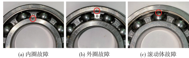
图 4 HUST 数据中人为加工产生的多种轴承故障
