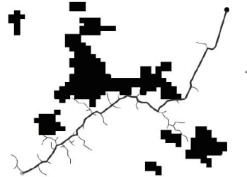
图 4 未采用车辆转角约束的规划路径
