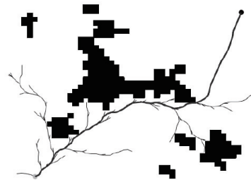
图 5 采用车辆转角约束的规划路径
