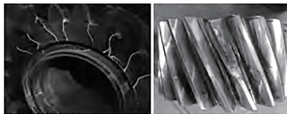
图 19 小齿轮破坏照片
