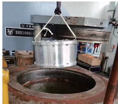
图 10 换能器高静水压试验现场图
