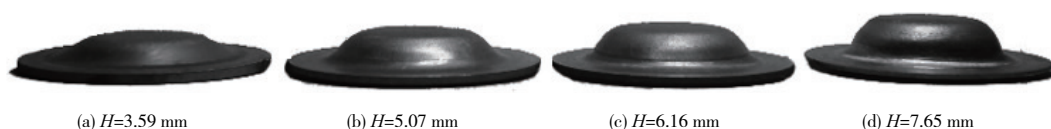
图3 压边圈—凹模通电拉深筒形件
