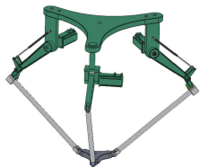
图 1 并联机构结构简图 图 2 并联机构三维模型
