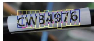
图 3 线缆编码文本候选框检测
