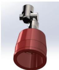
图 2 扇形压力式喷嘴三维模型
