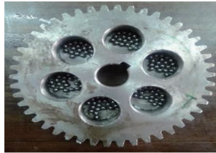
图 16 带颗粒阻尼的直齿轮
