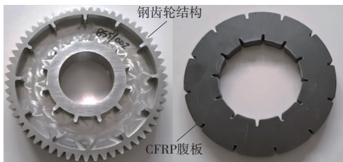
图 7 混合齿轮中金属与复合材料部件
