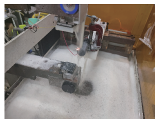
图8 硅材料电火花线切割现场
